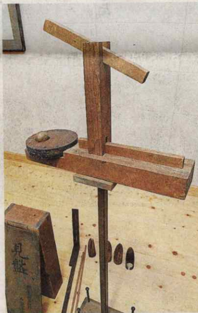
江戸後期の数学者・石川喜平が使用したという測量器具「見盤」 || 愛知県安城市
